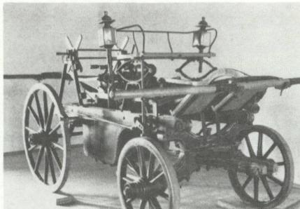
Fahrbare Feuerspritze von 1883 - mit den beiden Bügeln an der Vorder- und Rückseite wurde Wasser unter Druck gesetzt und in die Schläuche gepreßt.
